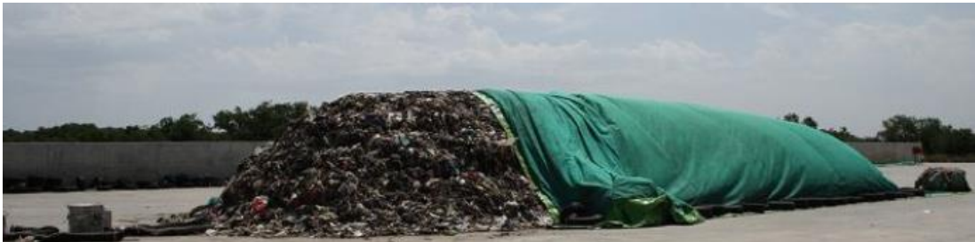
Figura 3.5: Exemplo de pilha de CDR sujeita a Bio-Secagem com Telas. Fonte: Mendes 2014
